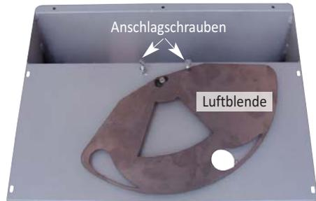
Nach Demontage des Lambda-Stellmotors mit Luftblende ist beim anschließenden Zusammenbau darauf zu achten, dass die Luftblende bis an den Kesselkörper ansteht.
