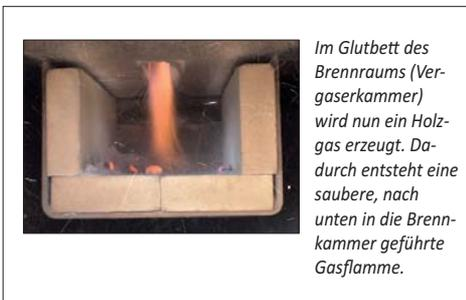
Im Glutbett des Brennraums (Vergaserkammer) wird nun ein Holzgas erzeugt. Dadurch entsteht eine saubere, nach unten in die Brennkammer geführte Gasflamme.
