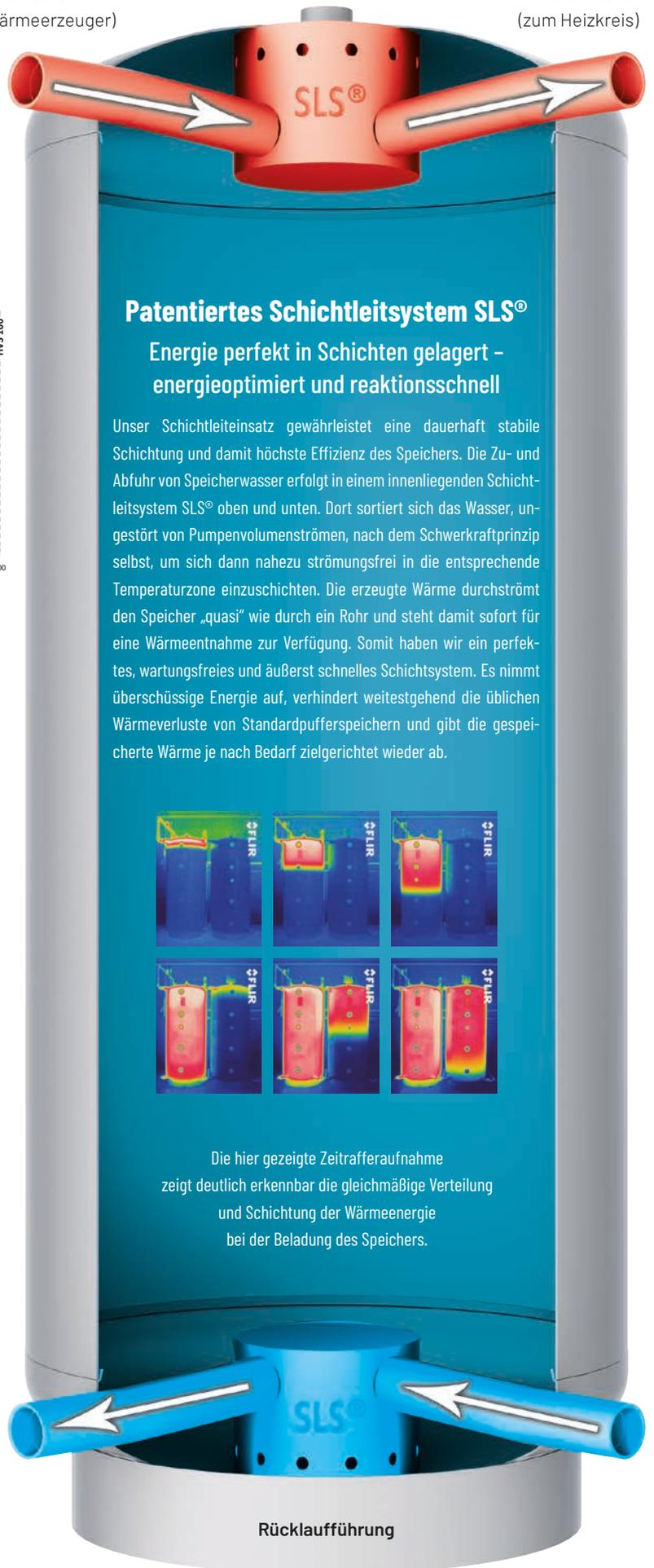
Die hier gezeigte Zeitrafferaufnahme zeigt deutlich erkennbar die gleichmäßige Verteilung und Schichtung der Wärmeenergie bei der Beladung des Speichers.
